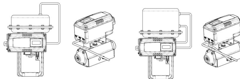
图：执行机构的气管连接例图
