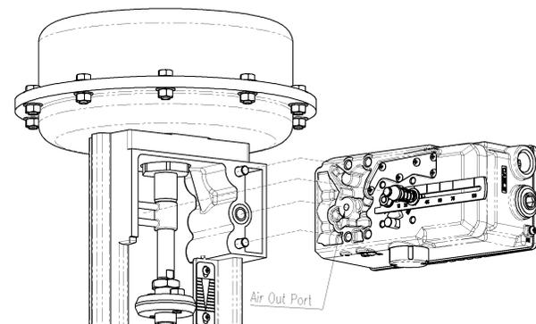
图：安装在无管路执行机构示意图
