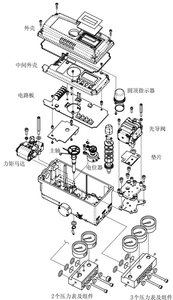
图：YT-3300L结构图
