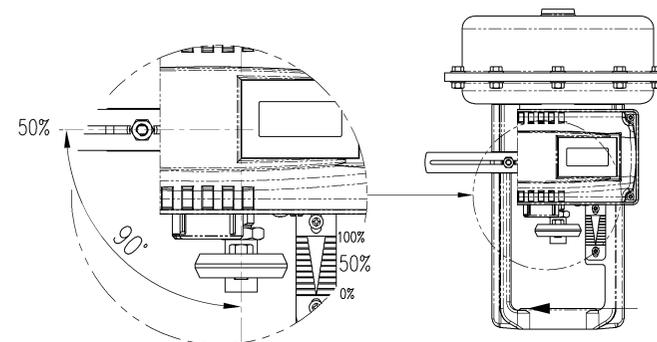
图：反馈杆正确成水平的状态图
